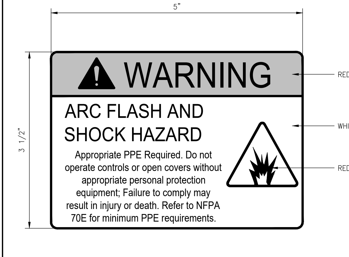
9 SHOCK HAZARD WARNING LABEL SCALE: N.T.S.
